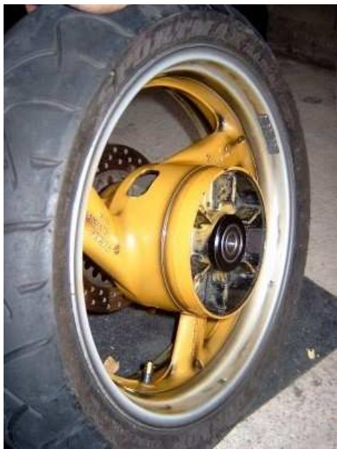
4. graissage des roulements de bras oscillant : sortir l'axe se trouvant a l'interieur, le nettoyer, et le recouvrir de graisse. pareil sur les roulements...passé le doigt dedans avec la graisse.
