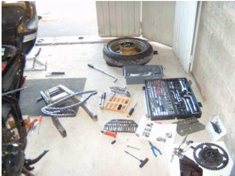
3. degraissement et nettoyage des differentes pieces : pour le degraissement un peu de gazoil fait tres bien l'affaire, puis frotter avec un chiffon sec.
