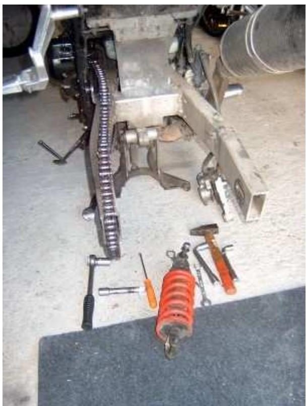
2.3. et du bras oscillant : l'axe du bras passe dans le cadre, il se trouve derriere les deux petit cache noir au dessus des cales pieds. la depose du bras oscillant permets de sortir la chaine entiere.
